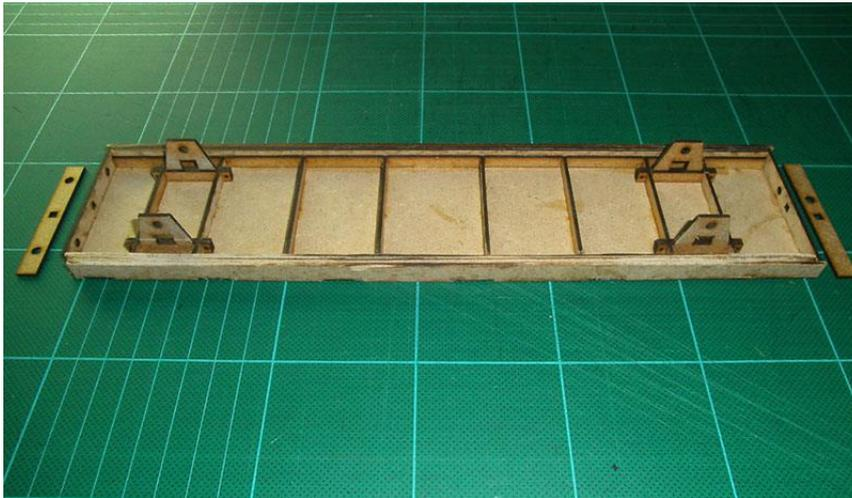
Die Deckplatte wird auf die Bodenplatte geklebt.
