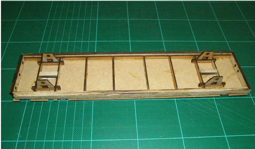
An die Innenseite des seitlichen Oberbaus werden die senkrechten Verstärkungen geklebt.
