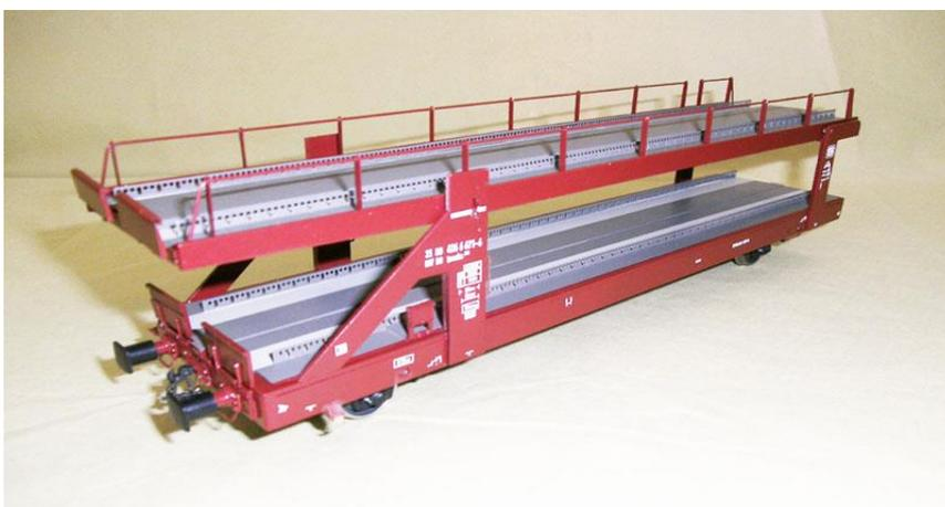
Die beide Wagenteile werden bis eine Laaeks 553 Einheit sehr eng und untrennbar gekuppelt (mit eine feste Kurzkupplungskulisse, ohne Haken).
