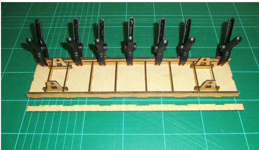
An die beiden Stirnseiten wird die Pufferbohle geklebt.
