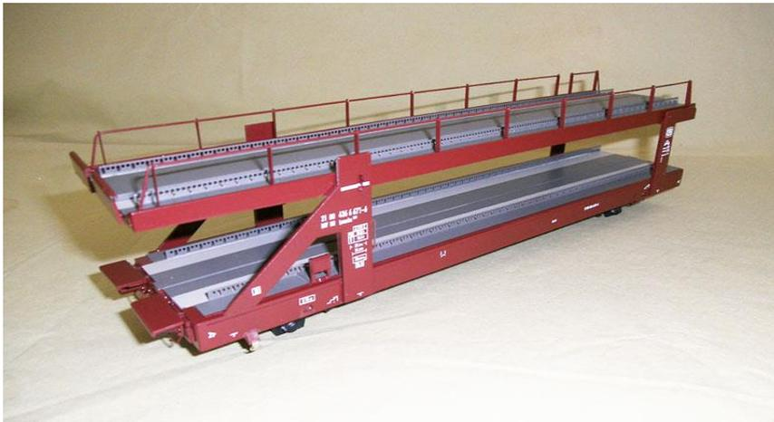
Schließlich werden die Federpuffer, Radsätze und Schraubenkupplungen montiert.
